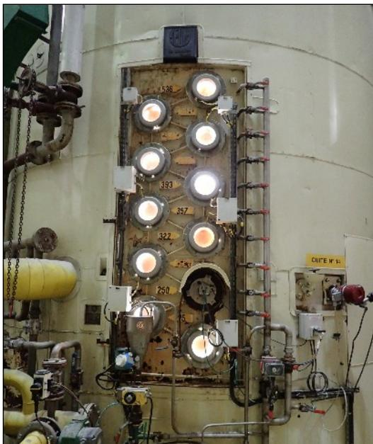
Les cuves à cristallisation pour les sirops épurés et concentrés
