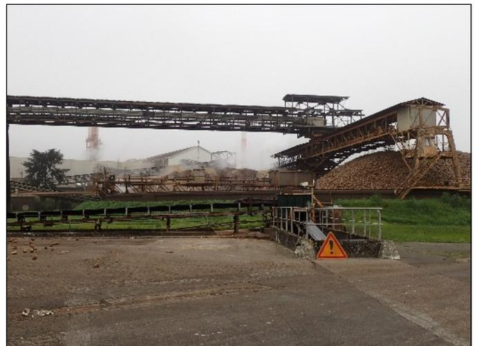
Les racines sont acheminées par une machinerie métallique qui tourne autour d'un plateau circulaire. Le pont aérien se termine par un bras perpendiculaire dans lequel un train alternatif répartit les racines sur la largeur du rayon du plateau.
