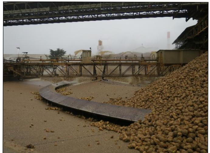
Au niveau du plateau, une rampe tournant avec l'ensemble de la machinerie métallique envoie de puissants jets d'eau sur les racines, qui sont lavées et entraînées vers un tunnel pour les traitements ultérieurs. Toutes les opérations sont automatisées et fonctionnent en continu 24 h / 24.
